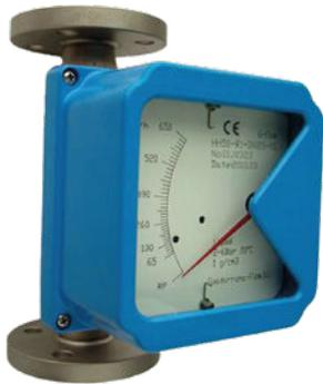
Son equipos que sirven para indicar, de forma local, el caudal instantáneo de líquido que está pasando en ese momento. Consiste en un elemento flotante que se encuentra en un tubo cónico donde la entrada es menor que la salida. El flotador es arrastrado al ir aumentando el caudal y se equilibra en un punto. A cada caudal corresponde un punto de equilibrio, por lo que **se puede calibrar el equipo directamente con el caudal.**
