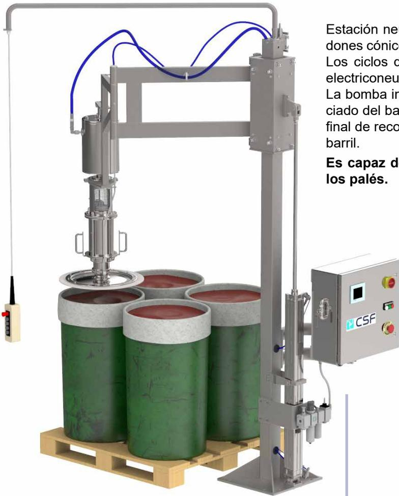
Estación neumática con brazo de doble articulación ideal para bidones cónicos y cilindros de hasta  $\varnothing$  700 mm y altura de 1000 mm. Los ciclos de trabajo la máquina se gestionan desde un cuadro electroneumático con PLC.
