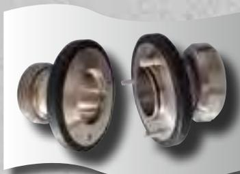
El conector CRT (sistema breakaway bajo tracción, por sus siglas en francés) está diseñado para desacoplarse cuando se somete a una gran tracción, en caso de desplazamiento de los equipos móviles conectados a la instalación.
