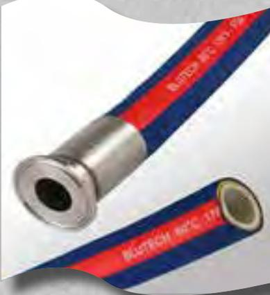
Butilo claro, refuerzo de entramados textiles y espiral de acero galvanizado embebida en la pared. Exterior Butilo azul impresión tela.
