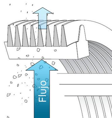
Principio de la filtración triangular.
