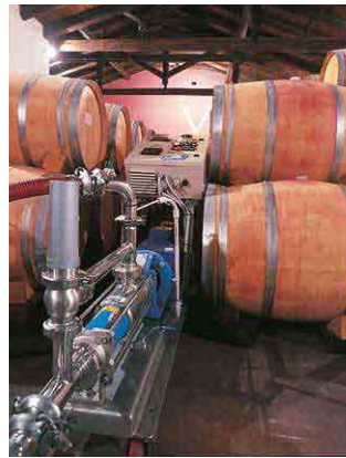
Serie MAE con tablero electrónico de control para boqueras de barricas
