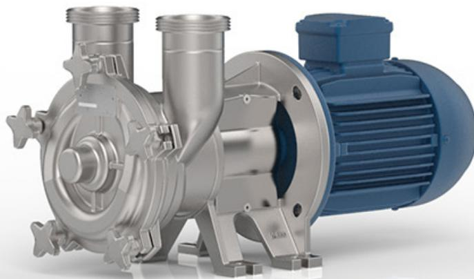
A 21- A31 : Bombas de ejecución monobloc con la turbina directamente montada sobre el eje del motor eléctrico. La tapa frontal puede extraerse aflojando tres pomos, sin desmontar ni la tubería de aspiración ni la de impulsión.
