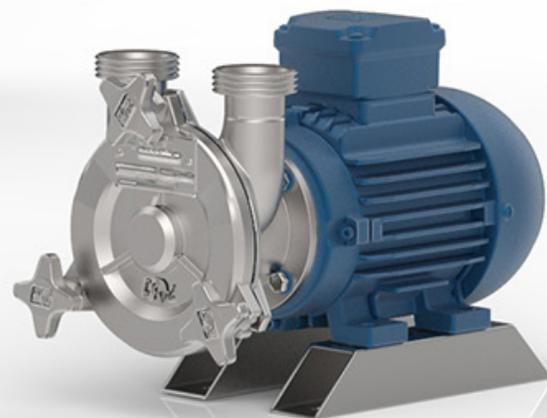
Realizadas completamente en acero inoxidable CF-8M 1.4408/AISI 316. Fundiciones realizadas a la cera perdida. Tratamiento de pulido electroquímico.
